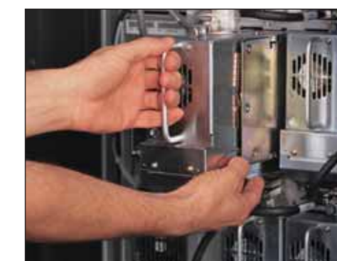
La technologie LiveSwap™ de la NEO vous permet de manipuler les lecteurs de bande sans interruption du bus SCSI.
