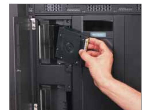
La conception des ports d'entrée sortie permet d'ajouter et de retirer facilement les cartouches sans interruption du système.
